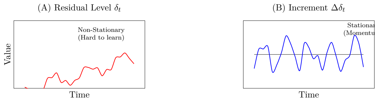
Figure 3: 学習対象の比較。(A) 対数残差 \delta_t は非定常なトレンドを含み、長期予測で分散が拡大しやすい。(B) 増分 \Delta\delta_t に変換することで信号が定常化（ゼロ平均化）され、LSTM による流行モメンタム（速度）の学習が安定する。
