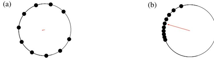
図 1 複素秩序変数の図示。黒く塗りつぶされた円が複素平面の単位円上に配置された振動子を表す。赤い矢印が複素秩序変数を表す。矢印の長さが  $R$  に、矢印の指す向きが  $\Theta$  に対応する。
