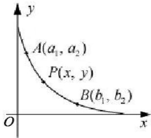
xy 平面上において求めたい曲線を  $y = \varphi(x)$  とおく。t を時刻、T を質点が 2 点間を滑り落ちるのにかかる時間とし、時刻 t に質点がある地点を  $P(x, y)$  とする。
