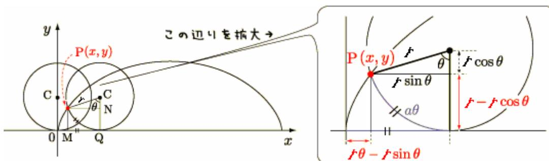
半径  $r$  の円を原点で  $x$  軸に接するような状態から転がし、その転がした角度を  $\theta$  とおくと、原点あった円周上の点が描く軌跡は上の図より、 $\theta$  を媒介変数として
