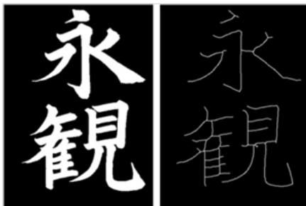
図 1.2 : 細線化処理前と処理後
